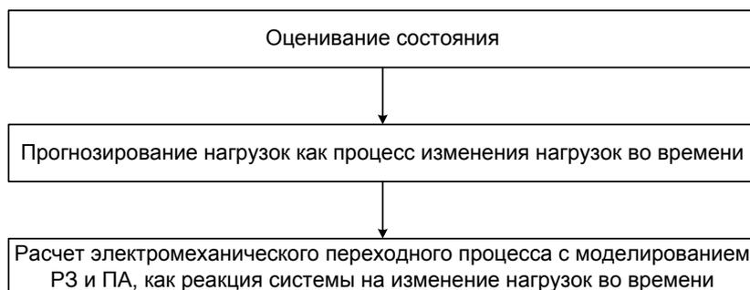
Рис. 2. Вариант алгоритма краткосрочного прогнозирования.
