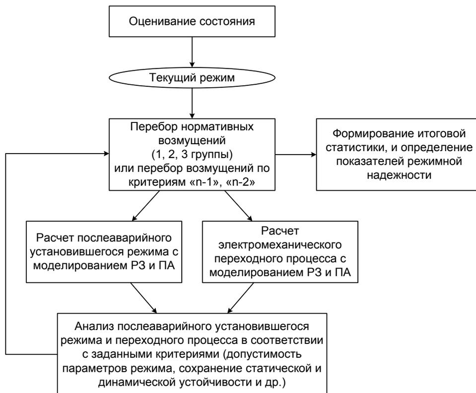
Рис. 1. Традиционный алгоритм анализа режимной надежности.
